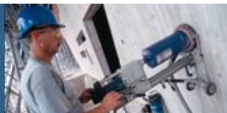
Sa stalkom za bušenje S 500 A Professional bušilica za bušenje dijamantskim krunama je savršeno pričvršćena za zid.
